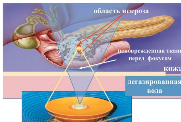
Рис. 2. Принцип действия аппарата.
